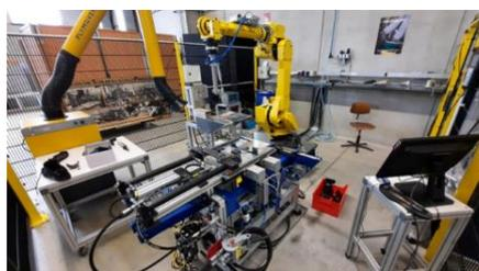
Abb.: Fraktionieranlage zur automatisierten Trennung von Schuhbestandteilen.
